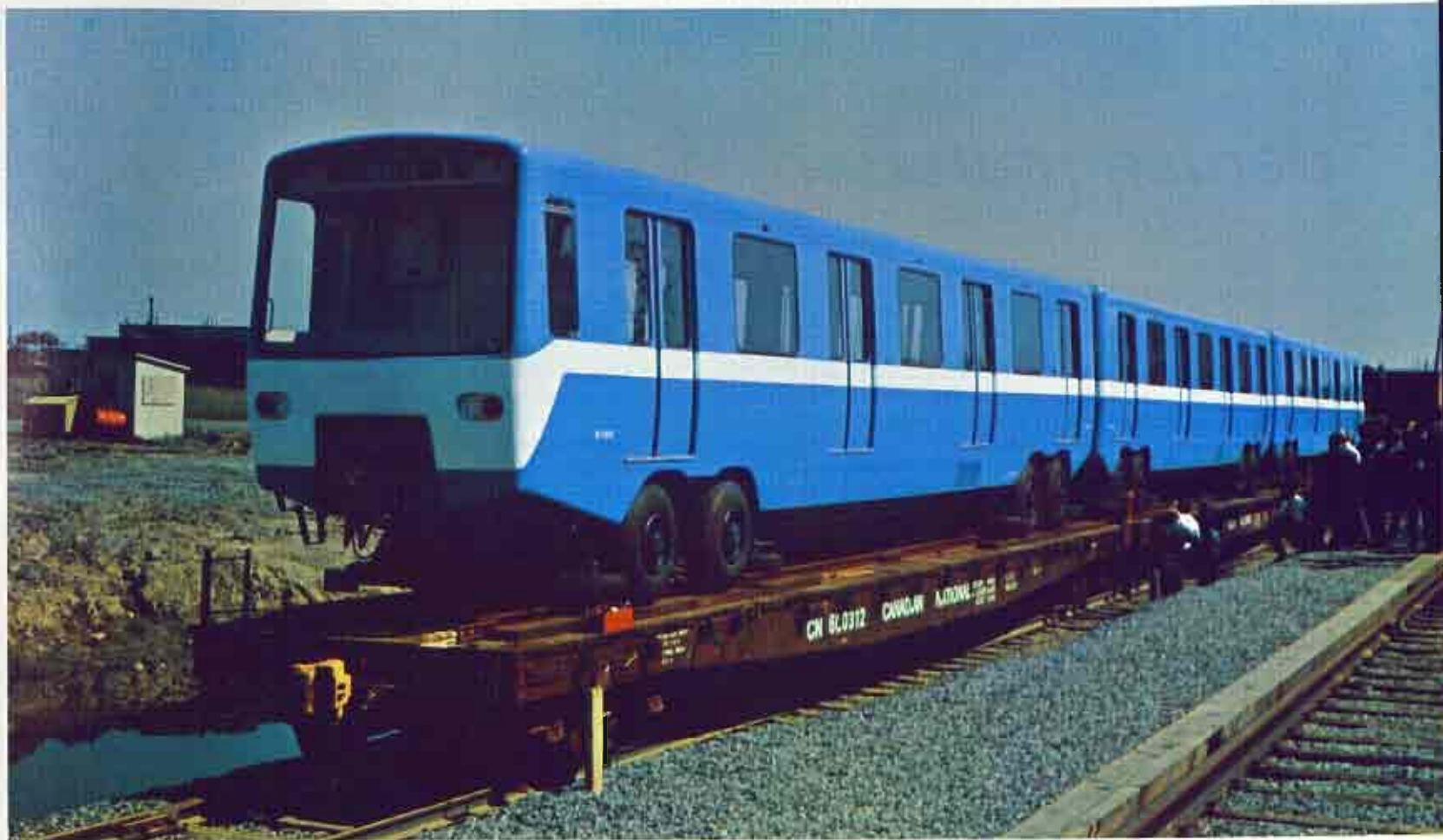
Les voitures construites dans les usines de la Canadian Vickers, rouleront sur pneumatiques • Streamlined subway cars were conceived and designed by Montreal Transportation Commission and Jacques Guillon and Associates, Montreal • Construidos en los talleres de la Canadian Vickers los coches rodarán sobre neumáticos • Le vettura costruite nelle officine della Canadian Vickers saranno dotate di pneumatici • Die in den kanadischen Vickers-Werken gebauten Stromlinien U-Bahnwagen werden auf Luftreifen rollen.
