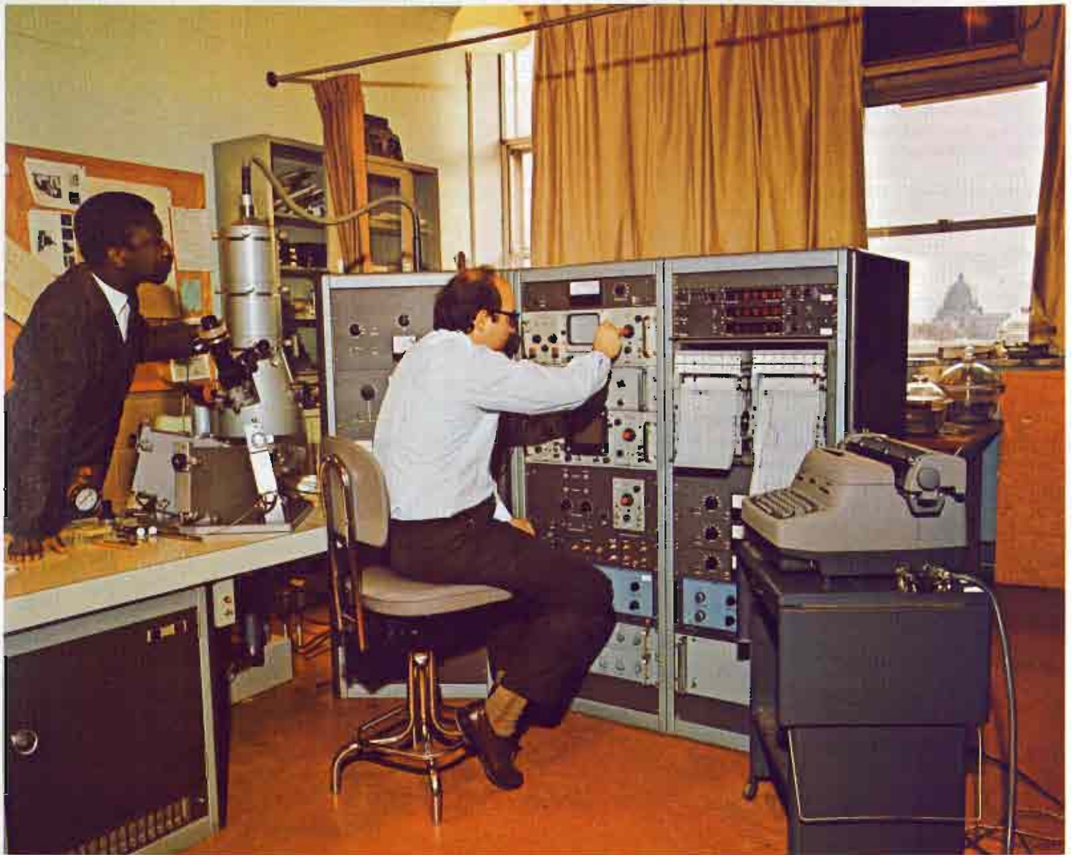
La microsonde électronique M.A.C. appliquée dans la microanalyse des minéraux au Département de Génie Géologique • The M.A.C. electron microprobe applications in mineral studies at Geological Engineering Department • La microsonda electrónica M.A.C. utilizada en el microanálisis de los minerales en el Departamento de Ingeniería Geológica • La microsonda elettronica M.A.C. applicata nella microanalisi dei minerali al Dipartimento di Ingegneria Geologica • Die elektronische Mikrosonde M.A.C. stellt Mikroanalysen von Mineralien für die geologische Abteilung her.
