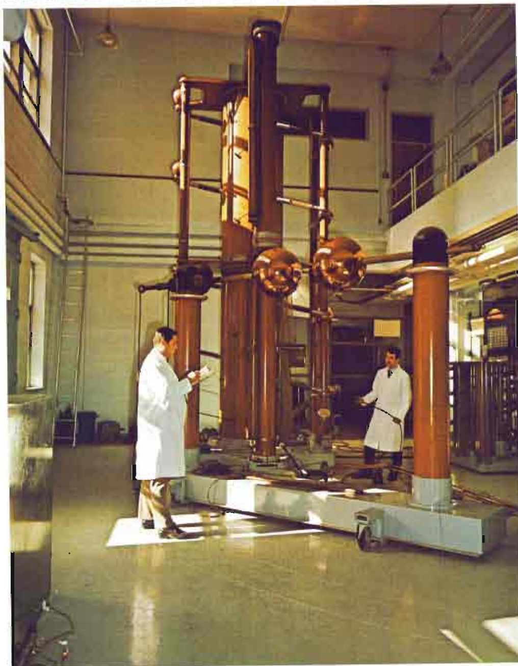
Le générateur d'ondes de choc du laboratoire des hautes tensions • Impulse generator of high voltage laboratory • El generador de ondas de choque del laboratorio de altas tensiones • Il generatore di impulsi del laboratorio delle alte tensioni • Der Impulsgenerator im Starkstrom Laboratorium.
