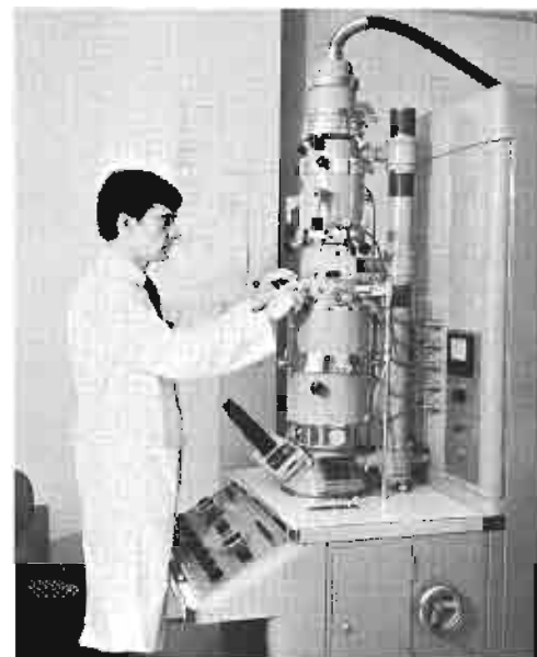
Vue du microscope électronique Jem-6 du département de génie métallurgique, utilisé en métallurgie physique et science du matériau • View of electron microscope Jem-6 of metallurgical engineering department, used in studies on physical metallurgy and materials science • Vista del microscopio elettronico Jem-6 del departamento de ingeniería metalúrgica, utilizado en metalurgia física y en ciencia de materiales • Veduta del microscopio elettronico Jem-6 del dipartimento di ingegneria metalúrgica, utilizzato nella metalurgia fisica e nella scienza del materiale • Ansicht des Elektronenmikroskops der Abteilung für Metalltechnik, das für Studien der physikalischen Metallurgie und Materialforschung benutzt wird.
