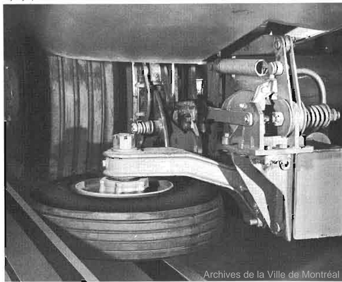
Les voitures roulent sur des bogies à pneumatiques conçus suivant des plans de la R.A.T.P. • Use of pneumatic tires on subway is based on Paris concept • Los coches ruedan sobre llantas neumáticas concebidas según los planos de la R.A.T.P. • L'uso di pneumatici è basato sul modello della R.A.T.P. • Die Wagen rollen auf Luftreifen, nach dem Vorbild der Pariser Métro.
