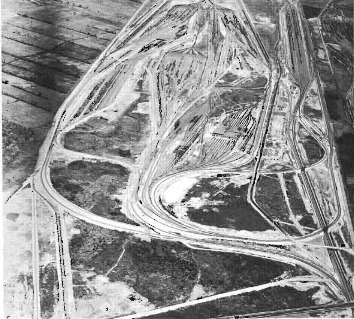
La nouvelle gare de triage est la plus moderne et automatisée au monde • St. Laurent hump yard has 165 miles of track, standing capacity of 11,000 freight cars • 265 kilomètres de via férrea con capacidad para 11 mil wagoes de mercancia • La nuova stazione di smistamento automatico per i vagoni merci è la più moderna del mondo: può manovrare 11.000 vagoni merci in un labirinto di binari della lunghezza totale di oltre 265 km • Der neue vollautomatisch betriebene Verschiebebahnhof, der modernste Güterbahnhof der Welt.
